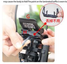
7: 上翻掀开车头松紧压盖G。 然后用螺丝刀或者板手从车头下面插进去, 往外撬出车头里面的塑料垫子H。这个垫子 仅供发货防止车头摔变形使用,到货去掉不用
