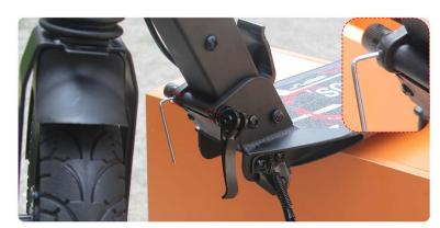
4: 如果折叠很紧按压不动折叠板手。或者车打开的时候很难固定到位。可以先用随车配置的最 细的内六角板手,插入图上所示的2个内六角顶丝孔里面,然后逆时针给小顶丝拧出来几圈。 然后再操作折叠和打开固定就比较轻松了。
