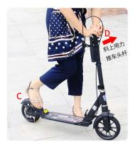
3: 让车保持立起来状态之后,保持车杆不动。 【后面超重点,务必照做】然后用一只脚踩住 后轮胎挡泥板C(挡泥板就是脚刹),让车处于 刹车状态不会移动。然后用双手抓住车头D, 往车前面斜上方使劲用力猛推一下。听到车 【啪】的一声响,车不会折叠了。然后观察 折叠挡板和车身是否平齐。以上动作最好一次 完成到位,以免多次操作不到位会造成车身折
