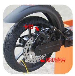
2: 给车放在桌子上,后轮悬空, 然后慢慢转动轮子观察碟刹盘有扭曲不平 偏摆的位置。可以先尝试用钳子稍微掰 一下修正刹车片,让它不摩擦即可。 新车没有磨合碟刹片会有轻微扭曲不平 属于正常,碟刹盘是软铁的,一般磨合 一些时间就好了。不是很严重不建议调。
