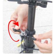
13: 重点: 务必锁紧本处高度锁扣,不然滑行 的时候杆子可能会突然下滑。锁紧方法如下: -手捏住黑色螺帽不动。然后另外一只手给高度 锁扣板手外翻打开到最大,然后顺时针使劲往紧 旋转锁扣板手。
