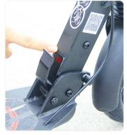
4: 检查D1所示的折叠挡板是否与车身平齐。 折叠挡板与车身平齐就是打开已经到位。 此时可以用你踩几次车身踏板,测试车身 折叠位置已经完全固定。
