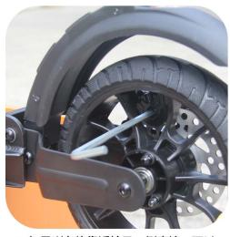
4: 如果刹车片靠近轮子一侧摩擦,可以 从轮子内侧用内六角板手插进去拧碟刹器 中间最大的一个内六角螺丝,可以左右适当 拧一下同时转动轮子测试,拧到碟刹器刹车 片有足够间隙容错,不会摩擦到即可。注意 这里的螺丝是起到调节作用,不是要单纯拧 紧。如果以上方法都调不好,可以配合第5 和6图的方法调节碟刹器卡钳左右位置即可。
