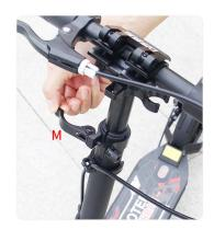
11: 打开高度调节锁扣M, 拧松高度锁扣螺丝帽。
