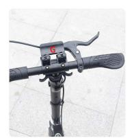
9: 装好效果如图,手闸i应该在右侧。注意 压盖G方向在前。如果车头方向不对,可以 360度整体旋转车头。让车安装好和本图保 持一致即可。
