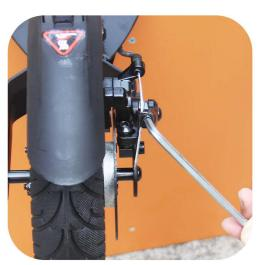
3:也可以观察碟刹盘如果外侧刹车线这边 摩擦,可以用内六角板手拧松刹车线的固 定螺丝,适当放松一点刹车线即可。
