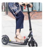
3: 折叠方法二: [2种方法二选一即可] 第一先用手往前推住车杆不放松。 第二同时捏住手闸Z不放松 第三脚悬空,用脚尖踢折叠板手B即可。 注意如果折叠板手太紧踢不动, 请先按
