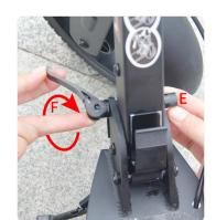
5: 一只手捏住脚扣螺帽E, 一只手将脚扣板手 F打开到最大,然后顺时针旋转板手,适当拧紧 脚扣板手到合适松紧度。
