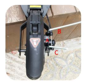
5:用内六角板手拧松上图的B和C的2个螺丝 注意拧松一小点,让碟刹器卡钳A可以移动即 可。请勿拧太松,太松碟刹器卡钳A晃动太大, 不容易掌握调节角度。
