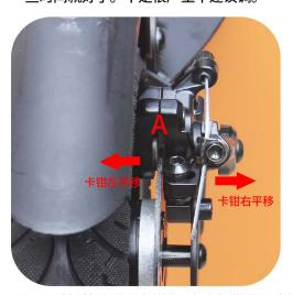
6: 用手抓着碟刹器卡钳A,左右轻微移动卡钳 同时慢慢转动轮子观察碟刹盘。找到碟刹盘不 会摩擦的角度,然后锁紧第5图拧开的B和C2个 螺丝。注意拧螺丝的时候要用手稳住卡钳A,保 持找好的最佳位置不动,然后慢慢交替拧紧B和 C的卡钳固定螺丝。避免拧螺丝的时候卡钳移位。 务必使劲拧紧螺丝,以免螺丝丢失或者错位。
