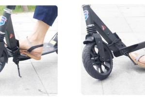
16: 如果脚撑打开之后车会右倒放置不稳。 首先确保车头没有安装车筐等影响重心的情况下。 只需要如图方法往左倾斜车身,让前轮轻微悬空, 然后脚踩踏板,加大一点脚撑角度即可放稳。
