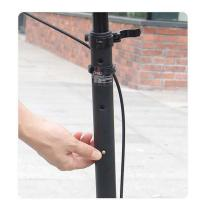
12: 车杆拉不动的时候,检查一下车中管的 孔位,是否有弹珠弹出卡住,如果有弹珠, 按住弹珠即可继续上下移动调节高度。
