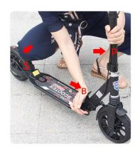
2: 折叠方法一[2种方法二选一即可] 第一先用手往前推住车杆P不放松。 第二用膝盖顶住后轮挡泥板S让车不往前跑。 第三用手掌使劲按压折叠板手B。按下去之后 在合上车杆即可。
