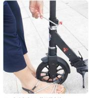
15: 车头角度不正的调节方法: 到货如车头角度不正或者车头会偏,只需要 人站在车前面,用双脚夹住前轮,手抓车头 调整好角度之后,用力锁紧中管锁扣<mark>N</mark>的2个 螺丝。注意拧这2个螺丝要交替用力拧紧。 直拧紧到车头不会再偏移角度为止。 15: Adjustment method for incorrect front angle:
