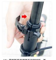
14: 直到板手很紧转不动的时候,再 用力内翻板手,让高度锁扣板手锁的更紧。 高度锁扣板手只有锁紧才不会丢失。每次 调节完毕高度务必记得锁紧。
