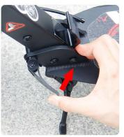
6: 垂直往内翻扣紧脚扣板手,此时板手会继续 锁紧车身。如果板手太紧,请勿暴力硬按,以免 板手断裂或者变形。可以适当逆时针松一点板手
