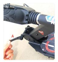
1: 外翻打开侧面脚扣板手(A所示位置); 让脚扣保持略微松动。 【注意仅需打开脚扣板手,切勿拆下脚扣螺丝。】
