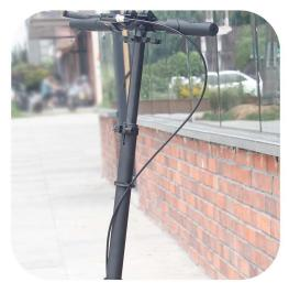
1: 后轮刹车有异常,首先检查刹车线没有在车杆缠绕。刹车线缠绕会导致刹 车异常制动或者异响。
